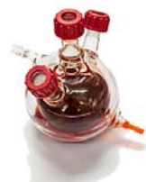
Matraz con doble cámara de pírex
