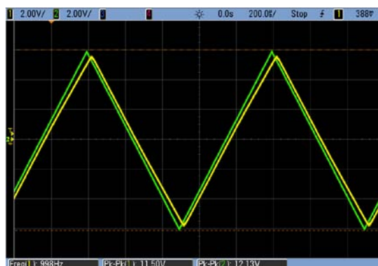
Señal de salida con carga de 1mH-0R5 a 1KHz y 12App
