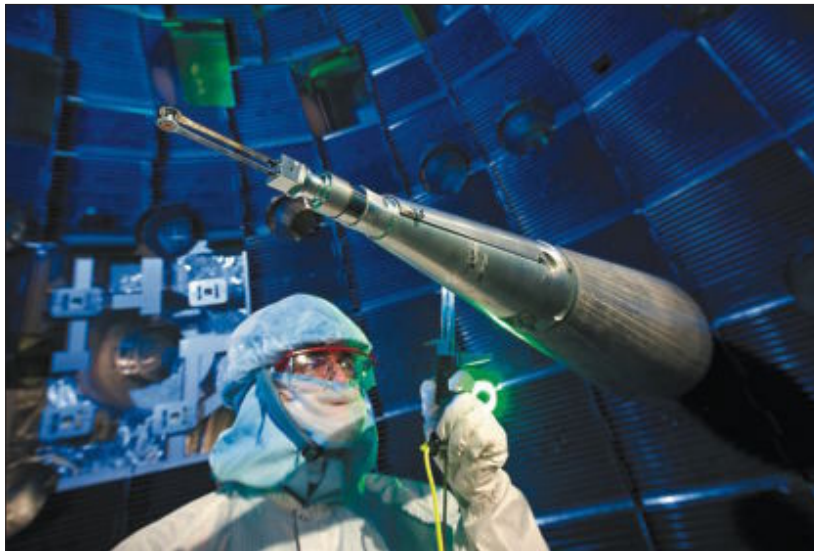
Un técnico sitúa en el NIF el blanco de convergencia de rayos láser para ensayos de fusión nuclear. / LLNL
