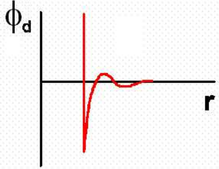
Figure 6: Gráfica esquemática del comportamiento del potencial de depleción exacto con la distancia entre partículas coloidales r : una parte dura, seguida de una parte atractiva, un máximo y sucesivas oscilaciones, cada vez más amortiguadas a medida que r aumenta.
