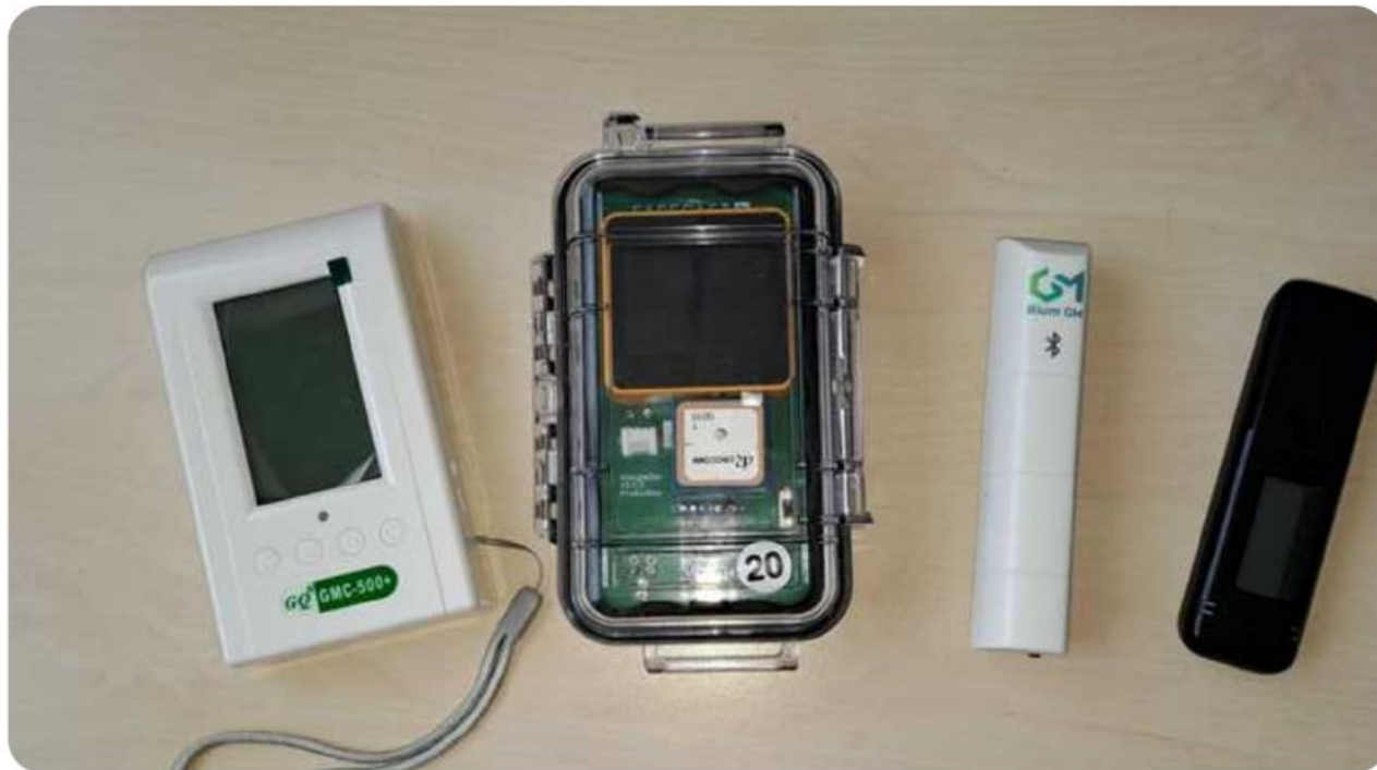
Figura 19. Algunos detectores analizados en Openred: doble tubo Geiger (GMC-500+), tubo Geiger BGeigieZen (SafeCast), tubo Geiger RIUMGM (OpenRadiation) y cristal centelleador (RadioCode 102). Fuente: Ibercivis.
