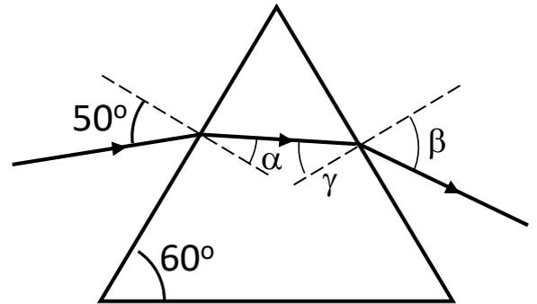
Aplicando la Ley de Snell a la cara de salida del haz de luz
