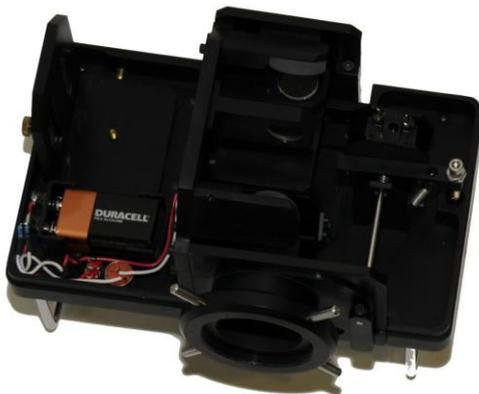
El **espectrógrafo** es un aparato capaz de analizar el espectro característico de un objeto celeste. Descompone la luz combinada que nos llega de las estrellas en sus diferentes frecuencias o longitudes de onda y permite el registro del resultado de la dispersión de la luz en un sensor, placa fotográfica o en la cámara CCD.
