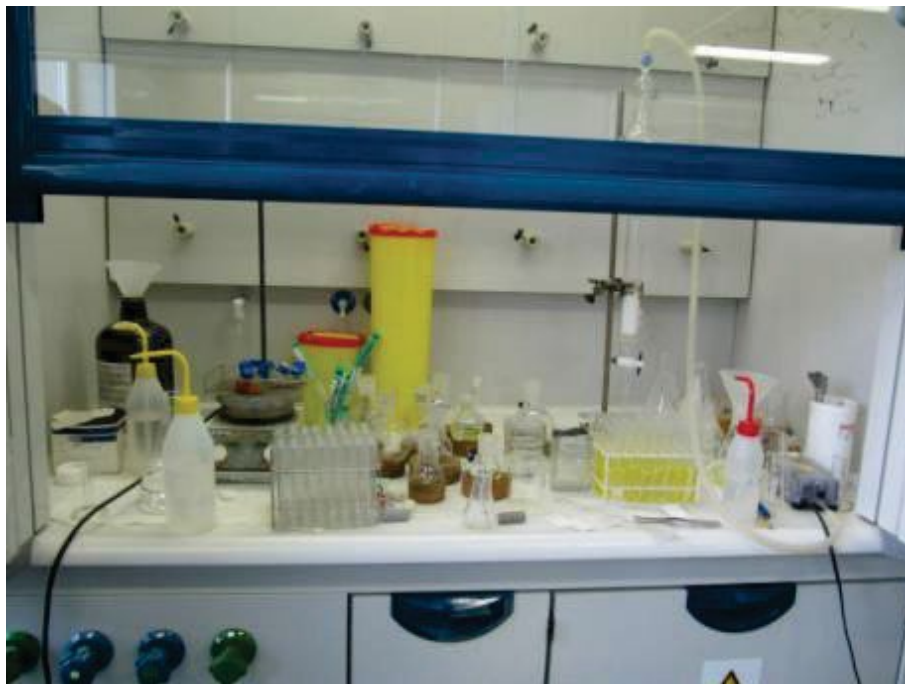
Foto 8. Vitrina con el interior lleno de utensilios. Imposible trabajar en ella en condiciones de seguridad
